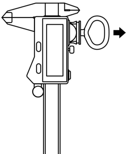
Pomocí přiloženého nástroje otevři oddíl pro baterii a vlož ji dovnitř.
