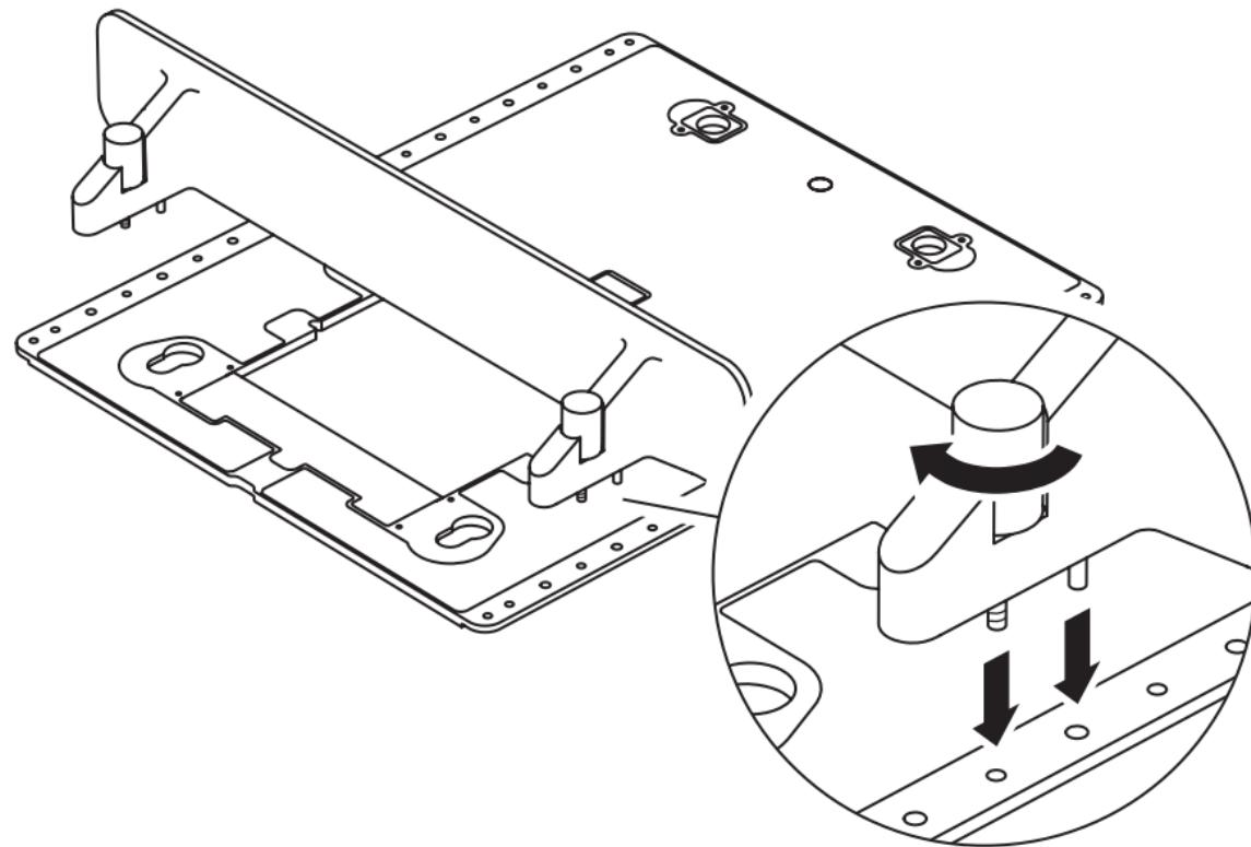
**Secure the Edge Mortising Adapter to Plate
